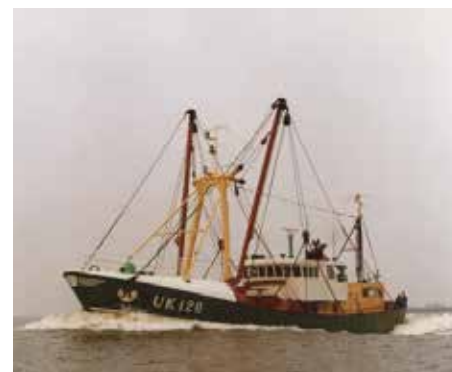
De ‘UK 126’ met zijn drieëndertig meter lengte en 1500 pk, was de grootste die afgeleverd werd. Opdrachtgever voor de bouw was Jurrie v.d. Berg op Urk
